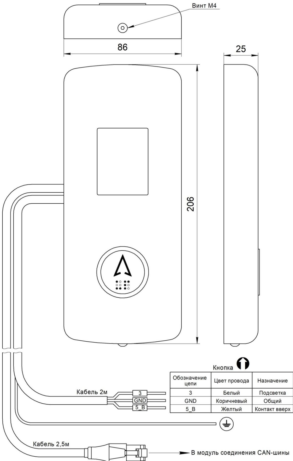
Рис.1 Внешний вид, габаритные и установочные размеры Вызывного поста ВП-1101-1086-07 (жгут RJ45)
